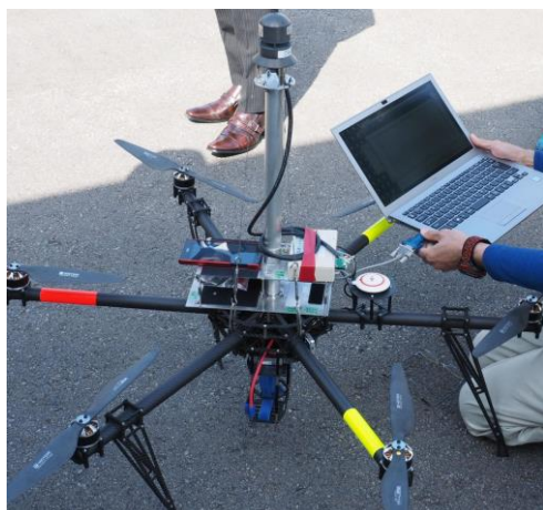
超小型超音波風向風速計を搭載したドローン 高度1,000メートルまでの飛行が可能
