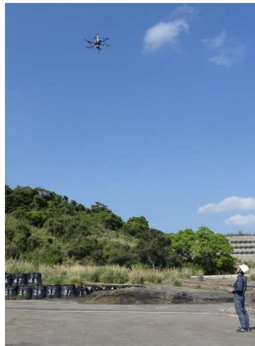
ドローンに複合気象センサーを搭載し、桜島周辺の高層気象を観測(4 月 18 日午後、鹿児島県鹿児島市桜島の有村地区にて)
