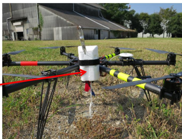
GPS ゾンデ発信機の UAV 搭載例
