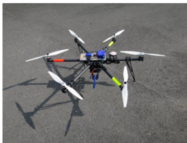
実証実験に使用したドローン（UAV）
