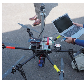
複合気象センサーを搭載し、鹿児島県の桜島周辺の高層気象を観測するドローン
