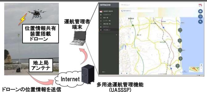
位置情報共有装置連携による多用途運航管理機能の飛行状況監視イメージ
