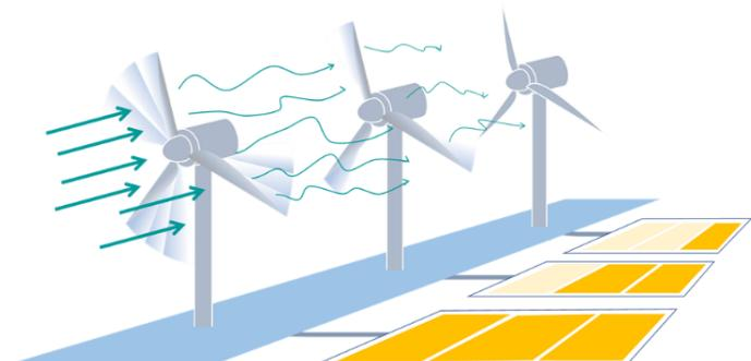
海域を有効活用するため、風車を近接して配置すると、後方（風下）風車は前方風車のウエイク領域に入る。
