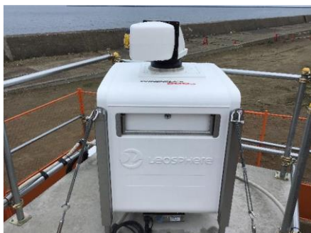
風況調査の観測機器 (スキヤニングライダー)
