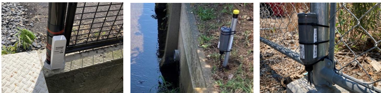
ワンコイン浸水センサの設置例
