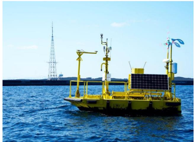
図3 フローティングライダー<sup>※2</sup>による観測の様子
