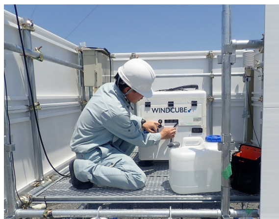
▲ 現地での定期点検
