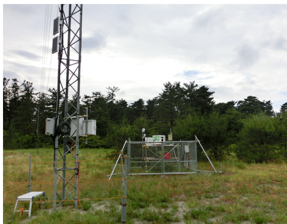
▲ 鉛直ライダーと風況観測マストの同時観測
