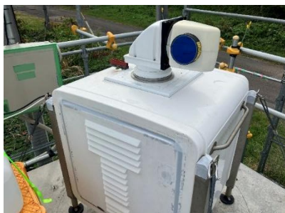
風況調査の観測機器 (例) スキヤニングライダー
