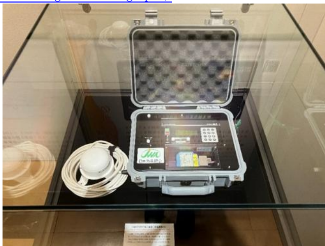
可搬型微気圧観測装置（微気圧計）
